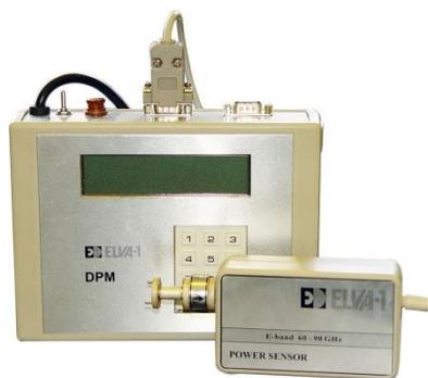
Schottky Barrier Detectorをベースとしているため、高速測定、高感度、高速反応が可能となります。センサーヘッドにはアイソレータが備え付けられており、入力された信号を正確に計測します。
