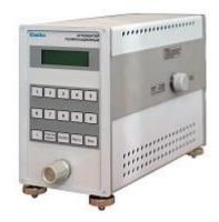
従来の抵抗可変型減衰器とは異なり、 可変減衰部にポラライザを用いた構造であるため、 再現性や減衰精度に優れています。 また、PCによるリモート制御、プッシュボタン式、ダイアル式と、 測定に便利な機能が一台に集約されています。
